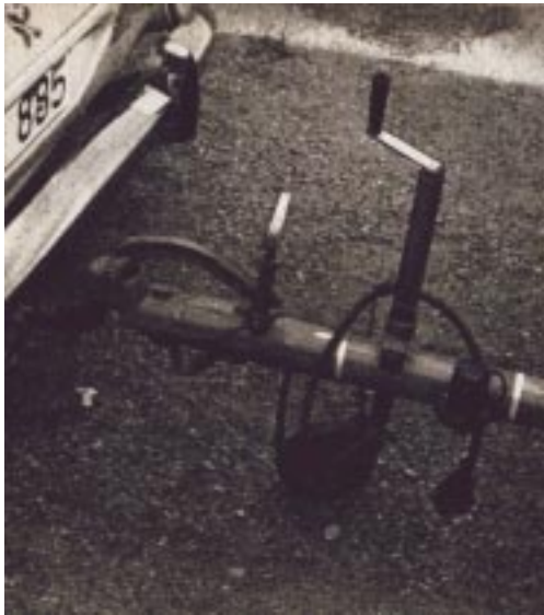
OHNE BREMSE lief der nur 320 kg schwere Wolf I kaum spürbar hinter dem Zugwagen.
