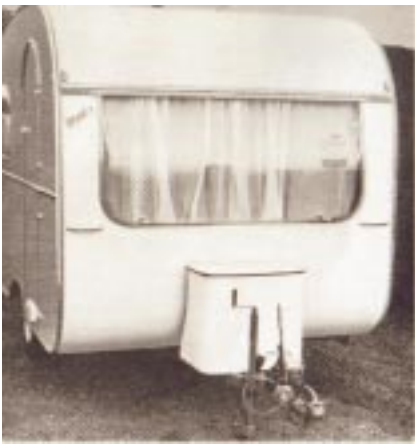
Mit Auflaufbremse und Deichselkasten
