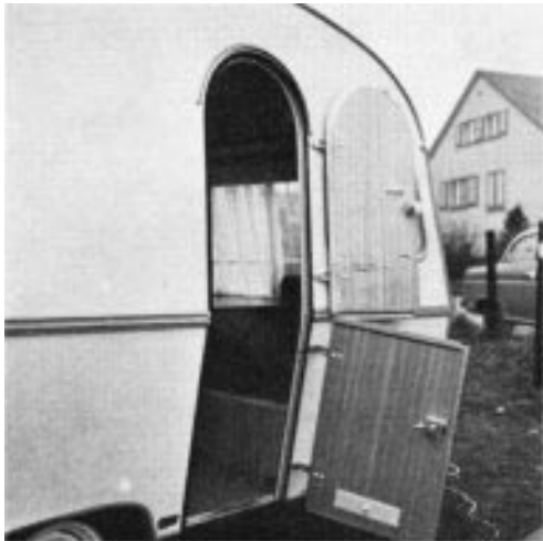
An der geöffneten geteilten Tür wird besonders die kantige Form deutlich. Ein wenig problematisch das Festhalten der unteren Türhälfte.
