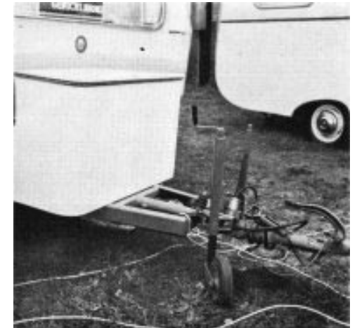
Ein Blick auf die Deichselgruppe. Deutlich erkennt man die interessante Kreuzung zwischen V-Fahrgestell und Rohrdeichsel.
